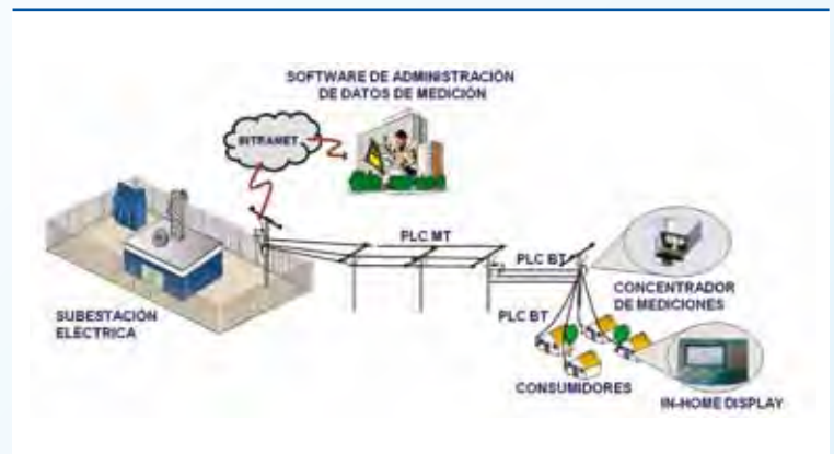
Figura 3a. Arquitectura SIM-IV para incorporar electrodomésticos al concepto de red eléctrica inteligente.
